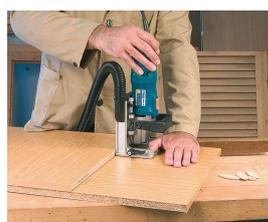
Ensamblaje en medio del tablero
