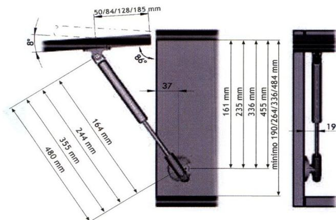
El compás de fricción es de nueva generación, siendo sus potencias y medidas regulables para controlar perfectamente la apertura vertical del mueble.
